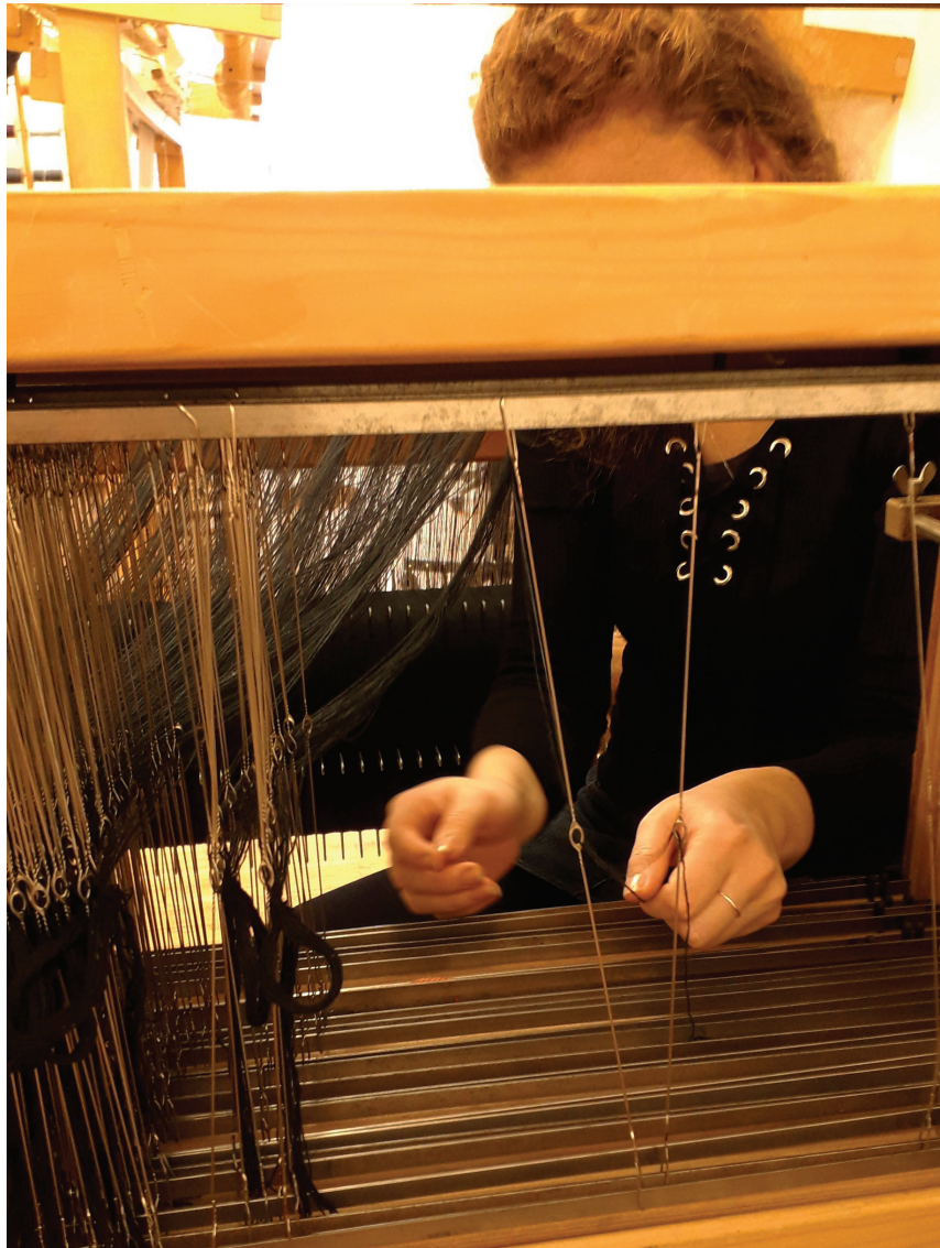
Abb. 3 Mit dem Litzenstechen ziehen die Kettfaden durch die Litzen
