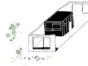
> Im Ergebnis ist das Basiselement eine komplette (ca. 54 m<sup>2</sup> große) Zweizimmerereinheit, die in einer Halle gefertigt und von dort zum Bestimmungsort geliefert wird.
