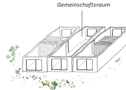
> Für den Erstbedarf kann diese fertige „Containerwohnung“ einzeln aufgestellt, in Gruppen kombiniert oder zu einem Haus zusammengesetzt werden.
